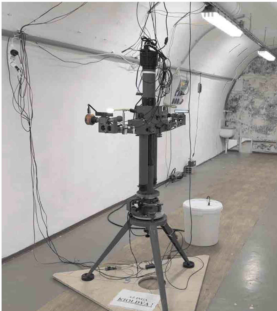
3. ábra. Az Eötvös-kísérlet újramérése 30 m mélységben a KFKI Jánossy Földalatti Laboratóriumában az átalakított Eötvös–Pekár-ingával.
