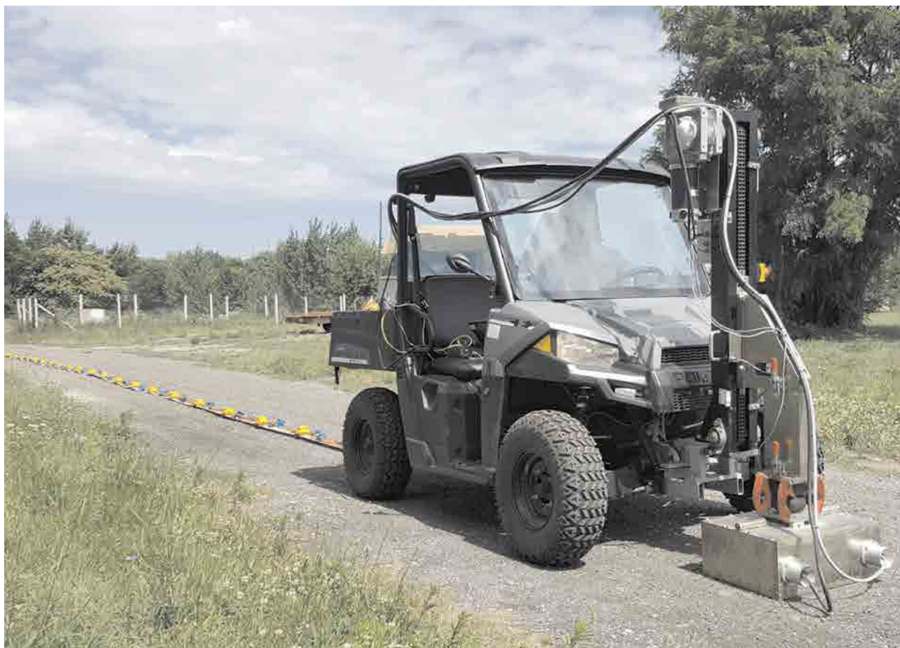
1. ábra. LandStreamer szeizmikus érzékelő rendszer és S-hullám vibroszeiz jelforrás mérés közben
