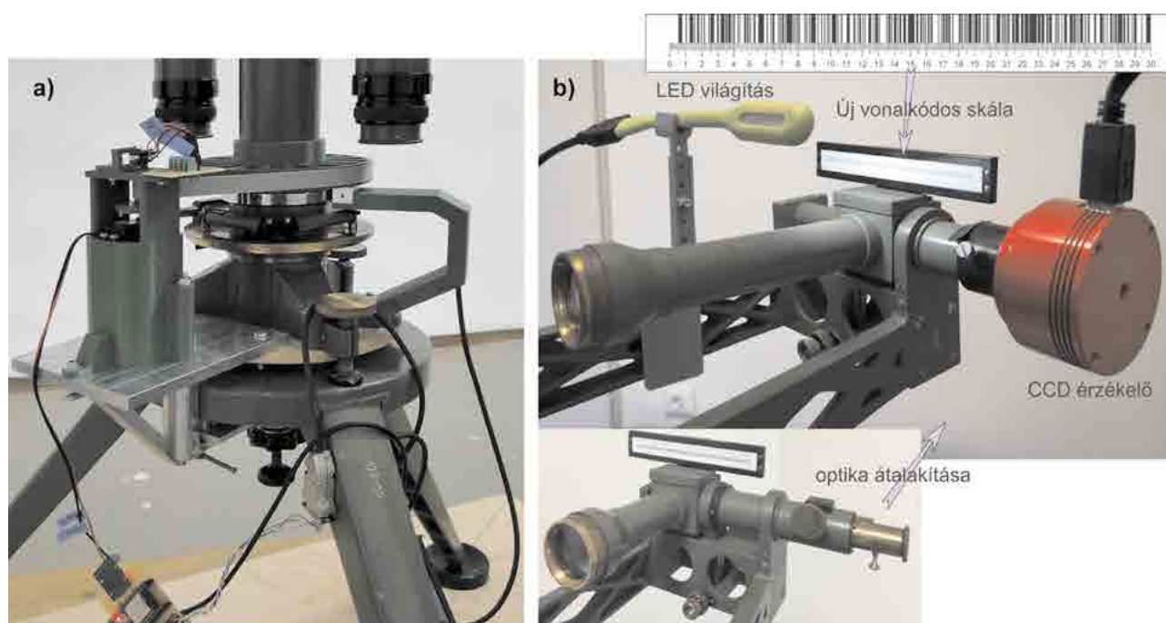
2. ábra. Távvezérelt forgatási mechanika és az automatizált műszerleolvasás kialakítása az Eötvös–Pekár-ingán.
