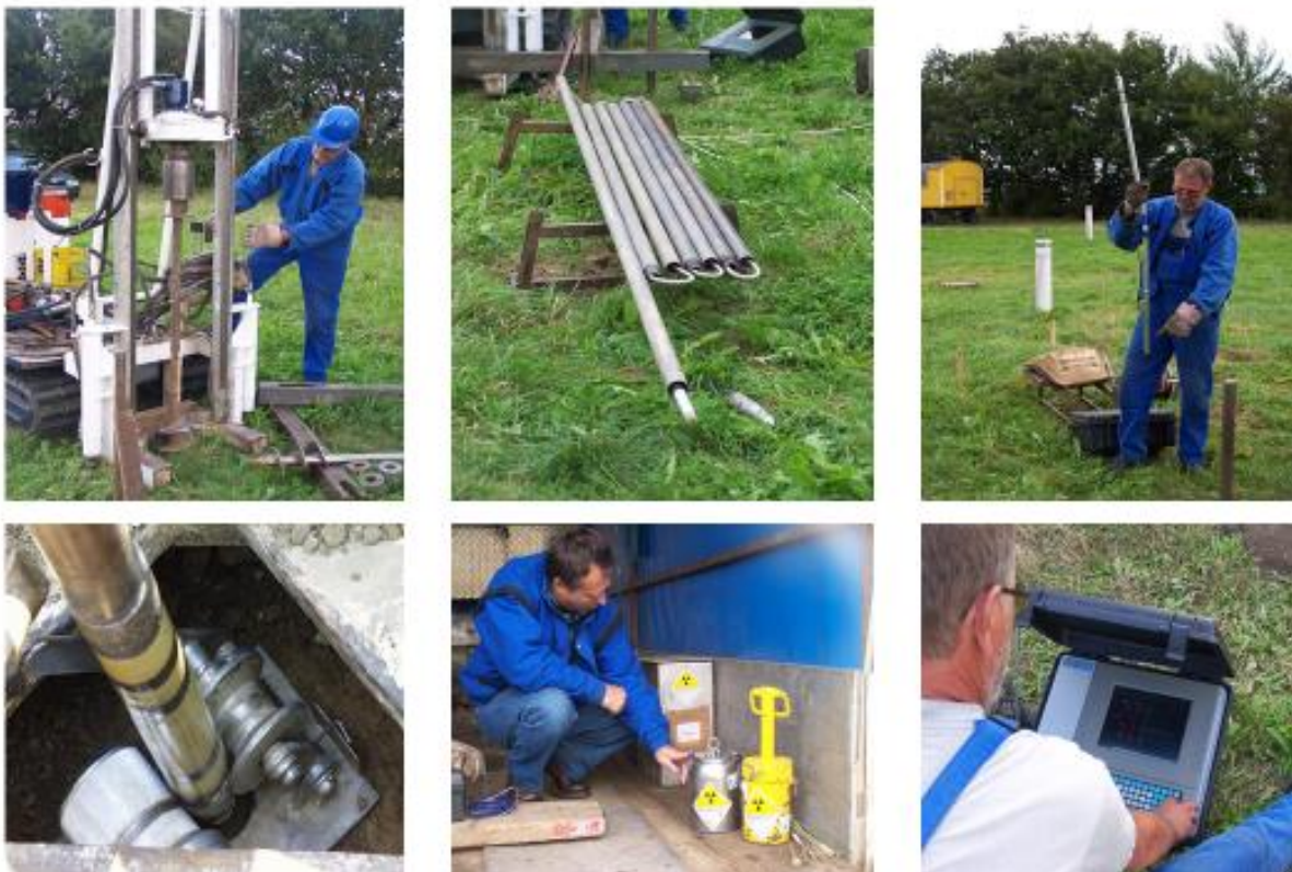
11. – 16. fotók: A mérnökgeofizikai szondázás (CPTe) eszközrendszere
