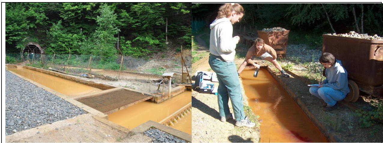
5. fotó: Az Altáróból kilépő felszínalatti víz mennyiségét automatikusan mérik 6. fotó: Környezetföldtani gyakorlaton a soproni hallgatók méréseket és vízmintázást végeznek
